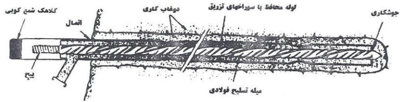
الف - میخ TBHA که توسط سولر نقر ابداع و به ثبت رسید
